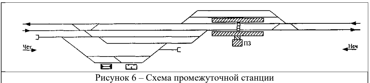
Рисунок 5 – Схема промежуточной станции
