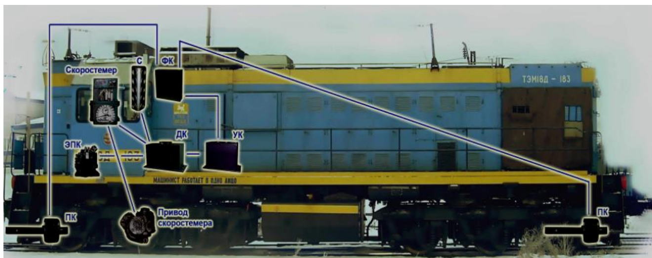
Рисунок 2.3 – Расположение локомотивных устройств АЛСН на однокабинном локомотиве
